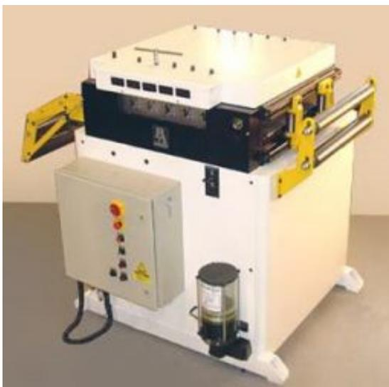
Die Bandrichtmaschinen werden nach Bandbreite, Richtwalzen-Durchmesser und Anzahl der Richtwalzen unterschieden.
