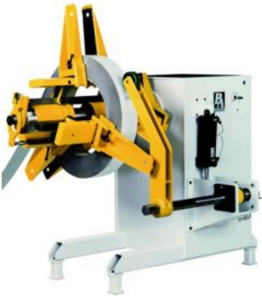
Die Haspeln lassen sich sowohl für Coil- und Bandmaterial, als auch als Draht-Haspel einsetzen. Je nach Anforderung finden Sie eine Einfach-Haspel oder Doppel-Abwickelhaspeln, horizontale Palettenhaspeln oder Spulenabwickler. Und passend zu den Abwickel-Haspeln bieten wir auch Aufwickel-Haspeln.
