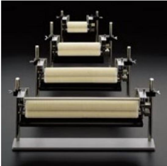
Die Bandöler für eine einfache Kontaktbeölung sind eine kostengünstige Ergänzung und schonen teure Stanzwerkzeuge. Die Rollenbandöler sind auch für ungerichtete Bänder problemlos einsetzbar. Die Filzwalzen werden durch Federn zusammen gepresst und beölen das durchlaufende Band.
